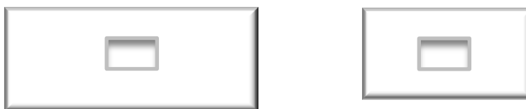
Figura 03: Soalhas de 30 cm e 15 cm com os devidos orifícios no centro
